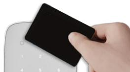
Die Bedienung erfolgt sinngleich wie unter Punkt 3 erklärt. Anstelle der Eingabe eines Benutzercodes halten Sie den Badge auf die Lesefläche des Bedienteils und drücken anschliessend die gewünschte Taste. Keine Ausschaltung unter Bedrohung möglich.
